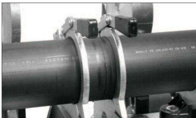
Správně připravené potrubí ke svařování
