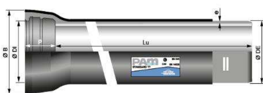
Trubka STANDARD TT-PE s jednokomorovým hrdlem STANDARD.
