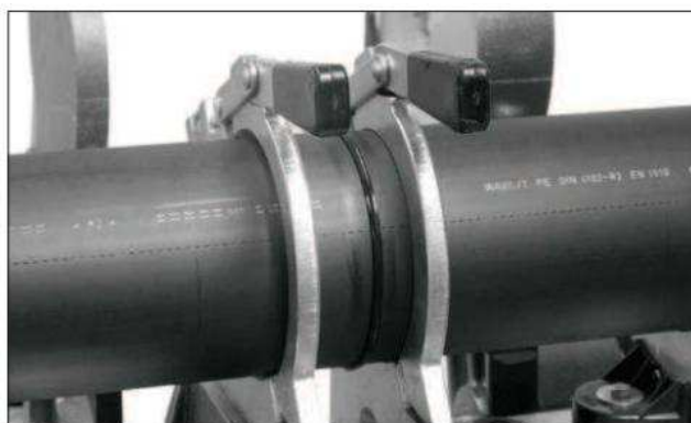
Chladnutí svařeného spoje
