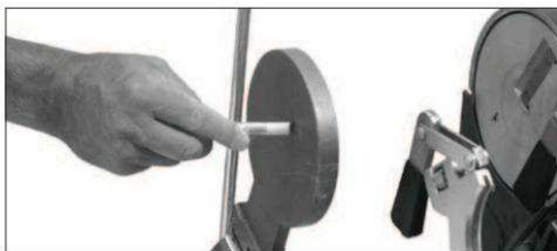
Kontrola teploty svařovacího zrcadla pyrometrem
